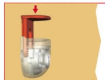
Baissez la partie supérieure dans la partie centrale jusqu'à ce que ça corresponde exactement à l'épaisseur de la vitre
