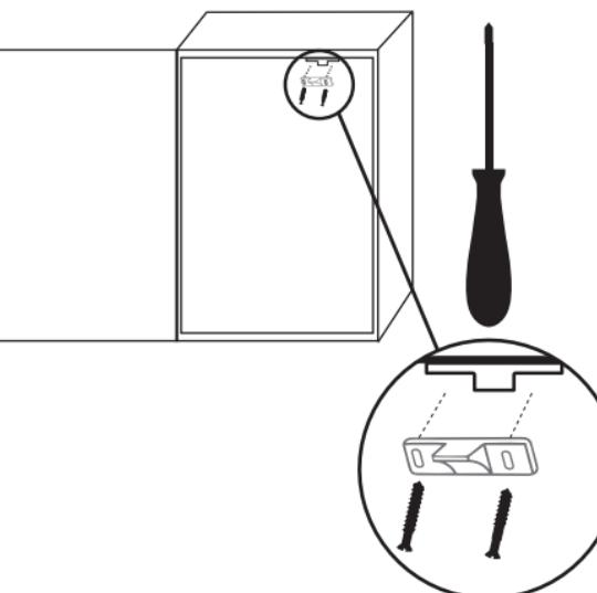
Alignez la plaque de frappe sur les deux emplacements marqués lors de l'étape 2. Utilisez les vis et installez-la de manière lâche afin que les ajustements puissent être effectués plus tard.
