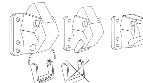
Insérez la barre de déverrouillage rouge dans le trou d'un côté, avec les lettres "unlock" orientées vers le haut. Ensuite, placez la barre au-dessus du boîtier et enclenchez le côté opposé.
