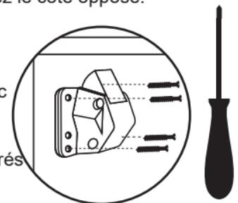
Alignez l'ensemble de verrouillage avec le poussoir sur le trou percé. Alignez avec les trous repérés et fixez à l'aide de vis de 1/2 pouce.
