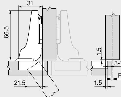
Décaler vers l'intérieur la position de fixation de l'embase de l'épaisseur de la façade FD +1.5 mm
