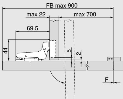
Dimensions charnière avec réglage d'usine (distance de l'embase = 0 mm)
