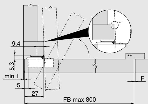
Dimensions charnière et calcul des jeux avec réglage d'usine
